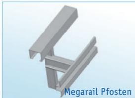
Die Pfostenklammer Megarail und Super Rail ECO für **Pfosten 125 x 65** wird an den Schutzplankenpfosten (Megarail und Super Rail Eco für Pfosten 125 x 65) angelegt. Der Überwurbügel kann dann auf die Schraube mit angeschweißter Unterlegscheibe gesetzt und mit dem Edelstahl-Knebel verriegelt werden.
