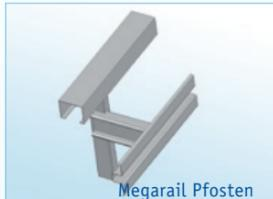
Die Pfostenklammer Megarail **für Pfosten 100 x 55** wird an den Schutzplankenpfosten (Megarail für Pfosten 100 x 55) angelegt. Der Überwurfbügel wird dann mit dem Edelstahl-Knebel verriegelt.
