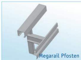
Die Pfostenklammer Megarail und Super Rail ECO „Universal“ für **Pfosten 100 x 55 und 125 x 65** wird an den Schutzplankenpfosten (Megarail und Super Rail Eco für Pfosten 100 x 55 oder 125 x 65) angelegt. Der Überwurfbügel kann dann auf die Schraube mit angeschweißter Unterlegscheibe gesetzt und mit dem Edelstahl-Knebel verriegelt werden.
