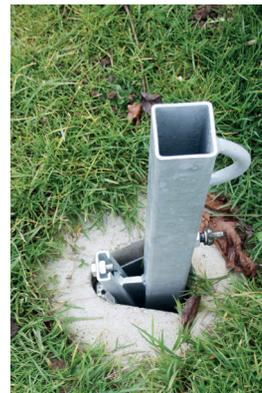
Der Halter für Leitpfostensockel mit Arretierung wird einfach nur in den Leitpfostensockel hineinsteckt. Durch die verschiebbare Arretierung sichert der Halter sich in dem Sockel. Das Stand-/Schaftrohr oder andere Aufstellvorrichtungen, einfach in die Aufnahme eingesteckt und mit einer Flügelschraube gesichert.
